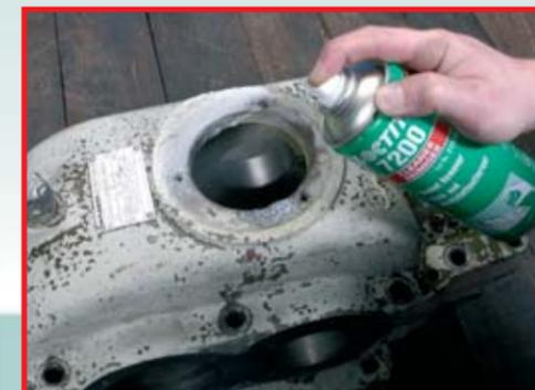
Usar Loctite® 7200 Quitajuntas para eliminar fácilmente las juntas sobre las bridas, reduciendo el raspado y evitando los posible daños sobre la superficie de las tapas
